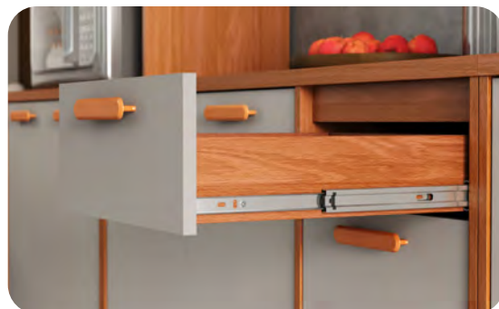
Corrediça telescópica de 35 mm, com 3 estágios, abertura total, trava de segurança e mais de 30 esferas de aço.
